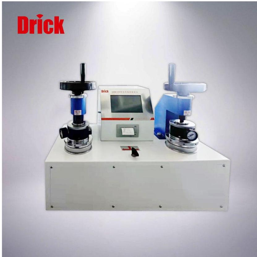
DRK109DH 手动双头耐破度仪是国际通用型缪伦（Mullen）式仪器是纸和纸板强度性能检测的基本仪器，本仪器操作简单、性能可靠、技术先进，是科研单位、造纸厂家、包装行业、质检部门不可缺少的理想设备。用于测定各种单层纸张及不高于2000kpa 的薄纸板也可用于丝绸棉布等非纸制品的检测。
