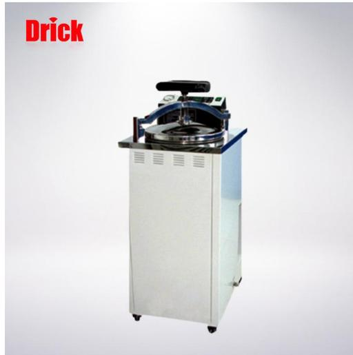
DRK137A 反压高温蒸煮锅设备适用于食品包装袋、胶粘剂、油墨印刷和相关薄膜等物品高温性能的蒸煮试验，也适用于食品科研单位无菌包装试验的理想设备。
