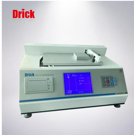
DRK127X 斜面摩擦系数仪专业适用于纸张、纸板、塑料薄膜、薄片、输送带等材料的摩擦系数测试。通过测量材料的爽滑性，可以控制调节包装袋的开口性、包装机的包装速度等生产质量工艺 指标，满足产品使用要求。
