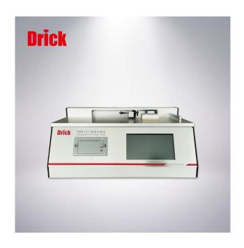
DRK127A 摩擦系数仪是我公司按相关国家标准规定研究开发采用现代机械设计理念和 微机处理技术进行精心合理设计的一种新型高精度智能型试验仪,采用先进的元器件、配套部件、单片微机,进行合理的构造和多功能设计,具有标准中包含的各种参数测试、转换、调节、显示、记忆、打印等功能。
