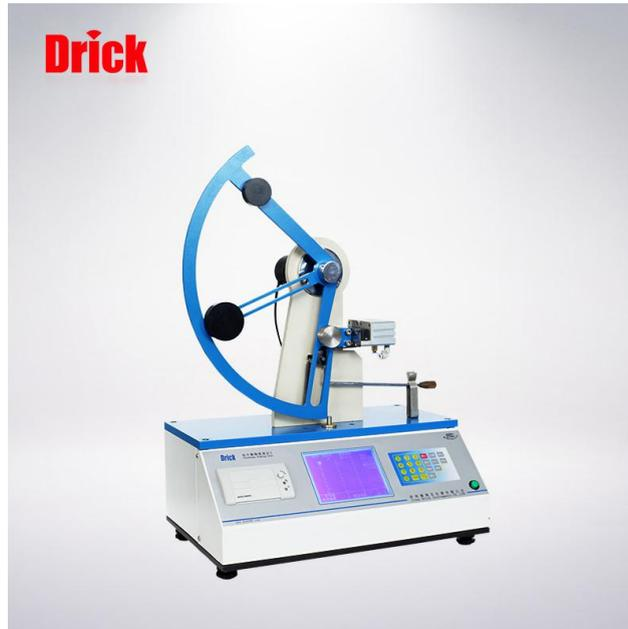
DRK108C 撕裂度仪专业适用于薄膜、薄片、软聚氯乙烯、聚偏二氯乙烯 (PVDC)、防水卷材、编织材料、聚烯烃、聚酯、纸张、纸板、纺织品和无纺布等耐撕裂性检测。
