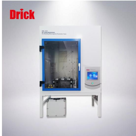
DRK-1070 阻干态微生物穿透实验仪系统由气源发生系统、检测主体、防护系统、控制系统等部分组成，用于对病人、医护人员和器械用手术单、手术衣和洁净服等进行阻干态微生物穿透试验方法。
