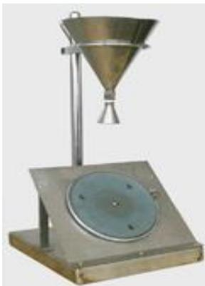
本仪器按照 GB4745-2012《纺织织物- 表面抗湿性测定方法--沾水试验法》设计制造，适用于测定已经或未经抗水或拒水整理织物表面的抗湿性(沾水)。
